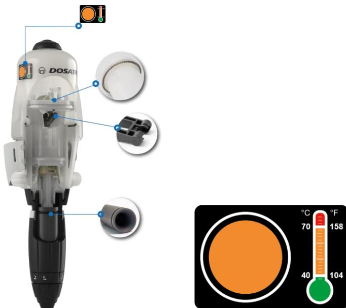
Die neuen Hochtemperaturgeräte D3TR, mit einem Gehäuse aus PVDF und Innenteilen aus PTFE/Grafeite-Compounds, gibt es in drei Varianten mit den gängigen Zudosierraten von 0,03 – 0,3%, 0,5 – 5% und 1 – 10%. Sie können für nahezu alle Säuren und Laugen in bekannten CIP-Reinigungsprozessen, sowie in mobilen oder zentralisierten Reinigungssystemen verwendet werden.
